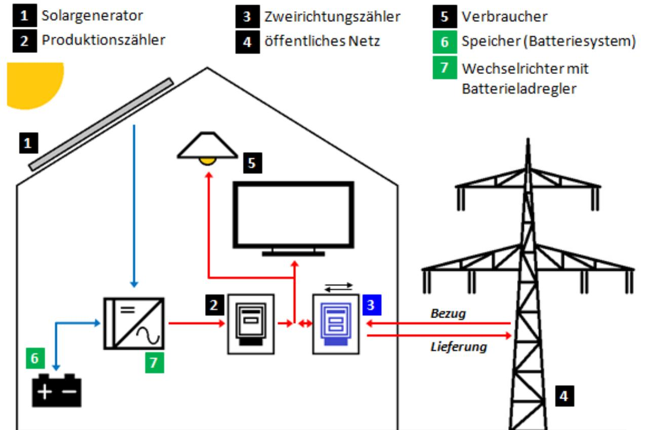
Photovoltaikanlage mit Eigenverbrauch und Energiespeicher (DC-gekoppelt)
