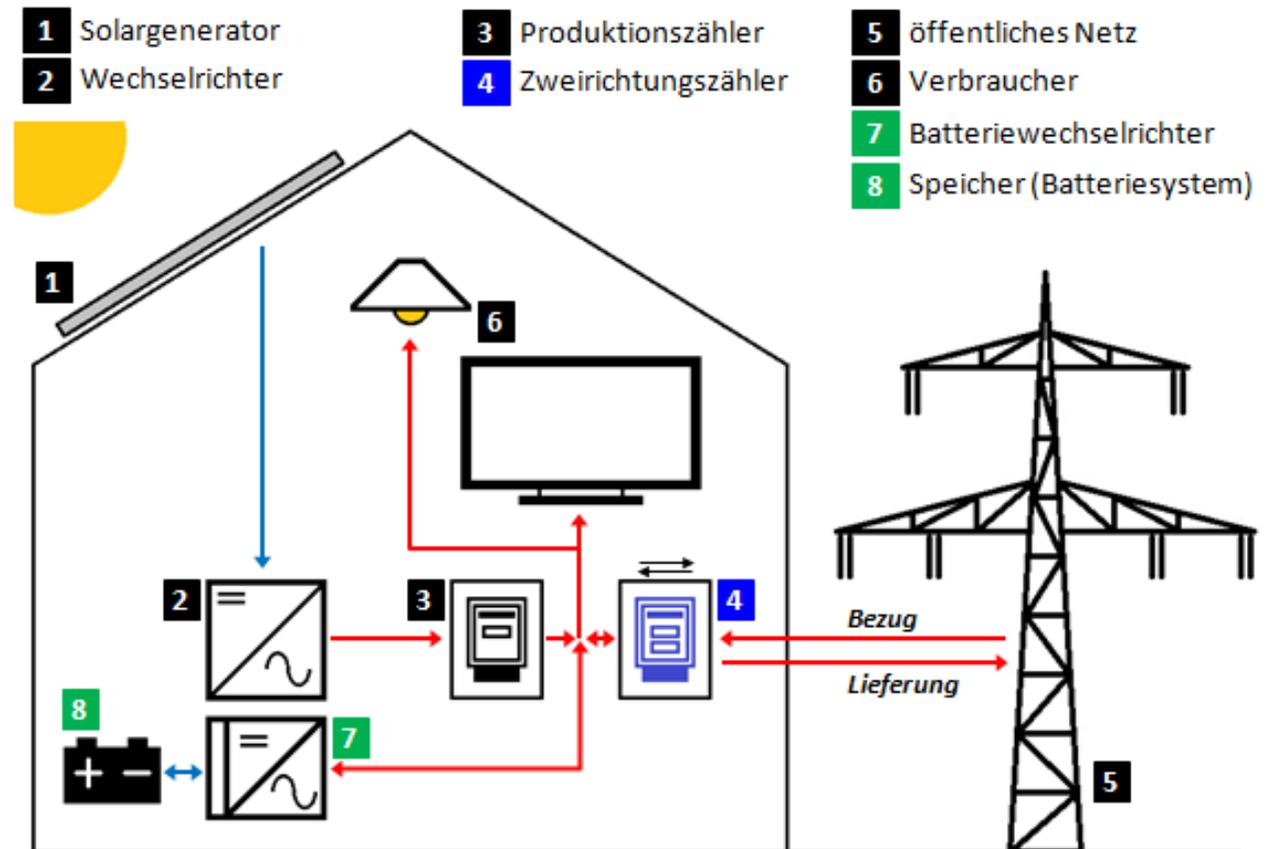
Photovoltaikanlage mit Eigenverbrauch und Energiespeicher (AC-gekoppelt)
